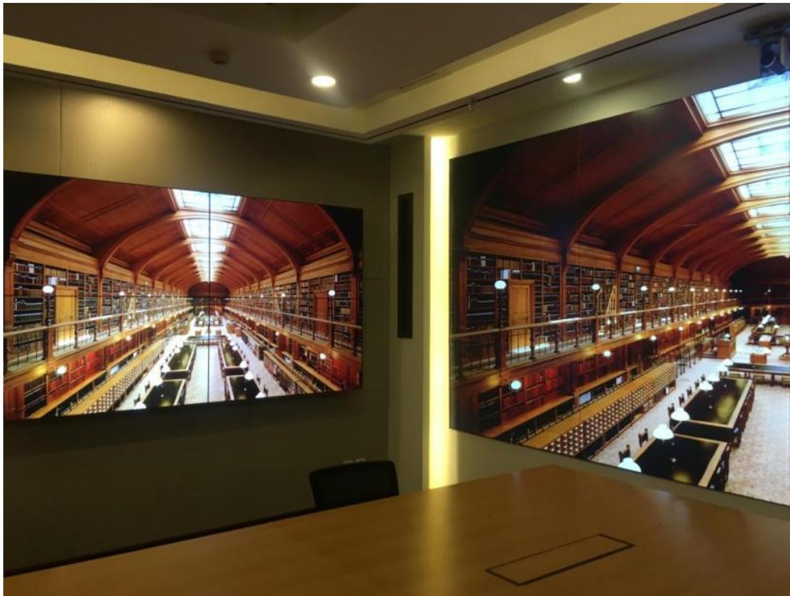
普通拼接（左）与零拼缝拼接（右）
